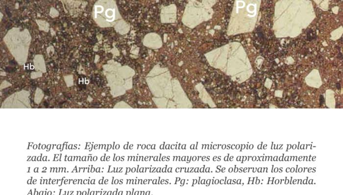
Fotografías: Ejemplo de roca dacita al microscopio de luz polarizada. El tamaño de los minerales mayores es de aproximadamente 1 a 2 mm. Arriba: Luz polarizada cruzada. Se observan los colores de interferencia de los minerales. Pg: plagioclasa, Hb: Hornblenda. Abajo: Luz polarizada plana.
